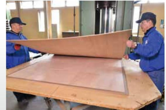
◆天板の製造工程は製品により20から30ほどある。写真は多層構造による天板材料の組み合わせ工程。この後、板を張り合わせる接着・プレス工程に回される
