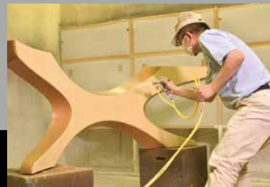
◆仕上げの塗装とクリアと呼ばれる仕上げ。まるでアートのような木脚部の完成
