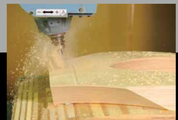
◆まるでバウムクーヘンのような積層の木の塊を削りだしていく工程。NC加工と呼ばれる
