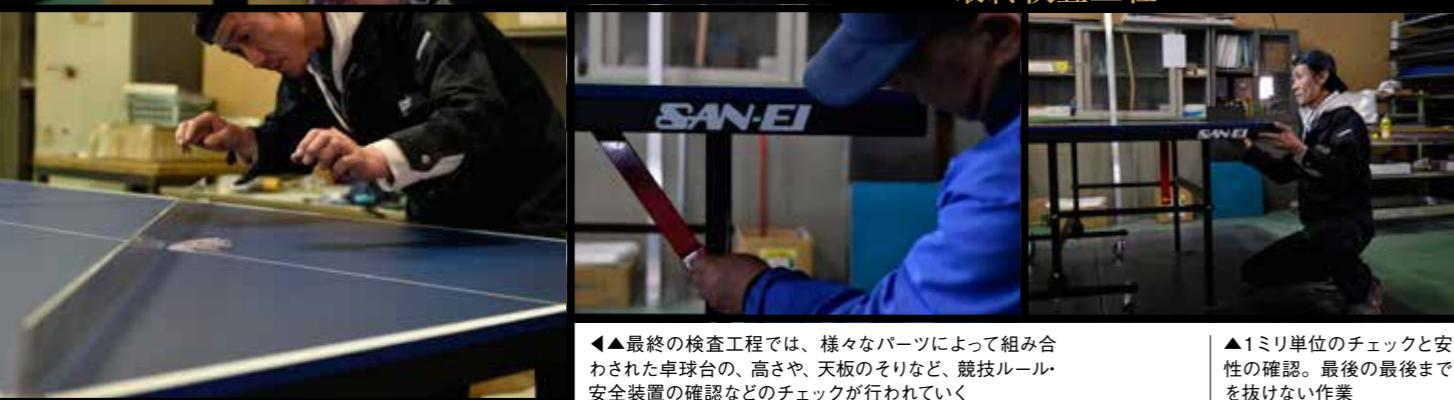
▲▲最終の検査工程では、様々なパートによって組み合わされた卓球台の、高さや、天板のそりなど、競技ルール・安全装置の確認などのチェックが行われていく
