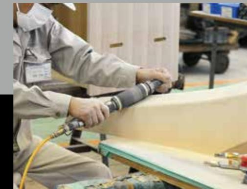
◆接合した脚部にヤスリをかけ、美しい曲面に仕上げていく
